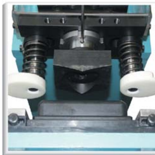
ابزارگیر سنیه و ماتریس، پیستون با میله میانی ضد چرخش
