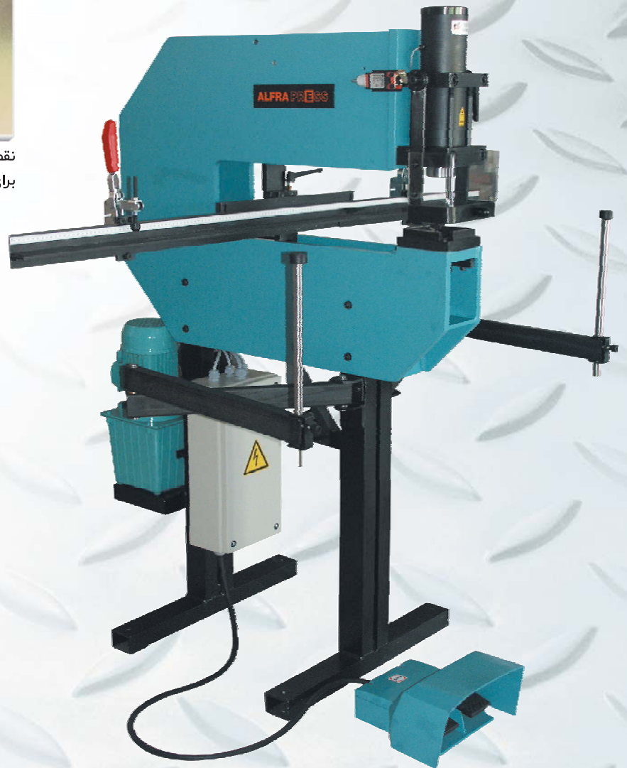
سیلندر هیدرولیک با قابلیت نصب نقطه یاب لیزری
