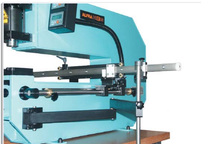
نگهدارنده طولی و عمقی قطعه کار در طرفین میز کار دارای دو تنظیم کننده روی محور Y
