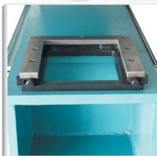
ابزارگیر ماتریس، حتی با وجود قطعه کار تعویض ماتریس بر راحتی انجام میگردد.
