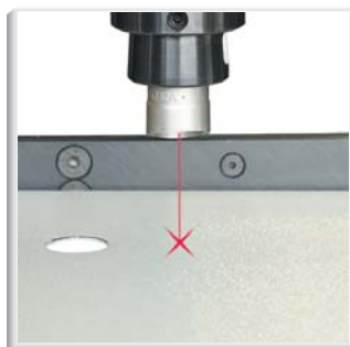
بوسیله اپراتور نقطه یاب لیزری محل دقیق سوراخ شناسائی میشود/
