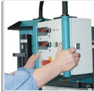
کنترل پنل با عملکرد دو دست
