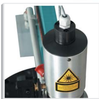
سیلندر هیدرولیک با قابلیت نصب نقطه یاب لیزری
