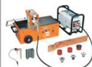
دستگاه برش، خم و سوراخکاری تسمه های مسی صفحات ۱/۴۰-۱/۳۱
